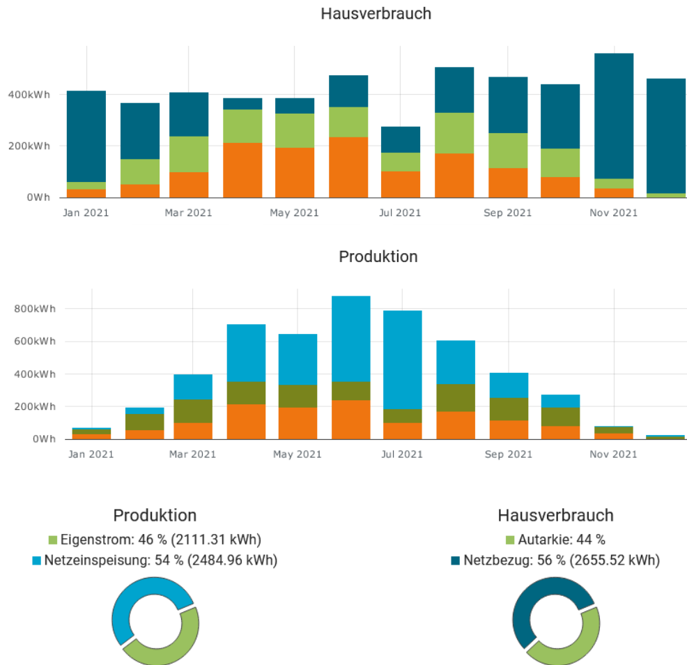
Abbildung 27: Hausverbrauch (oben) und Stromproduktion eines Einfamilienhauses (4 Personen) mit einer 6,9 kWpk-PV-Anlage in Kiel. Orange zeigt den Strom der direkt verbraucht wurde, grün den Strom, der zunächst im 6 kWh-Speicher zwischengespeichert wurde, dunkelblau den Anteil von bezogenem Netzstrom, hellblau den Anteil der Netzeinspeisung
